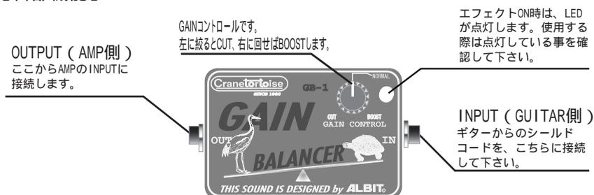
注：INPUTにギターのシールドを差し込むことによって電源がONされ、LEDが点灯します。電池駆動の場合は使用時以外、必ずプラグを抜いて下さい。
